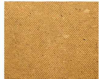
Abb. 14: Siebgenarbte Unterseite einer Hartfaserplatte
