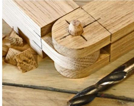
Abb. 30: 180°-Gelenk fertig montiert
