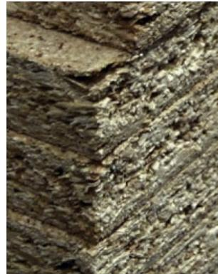
Abb. 12: Spanplatten
