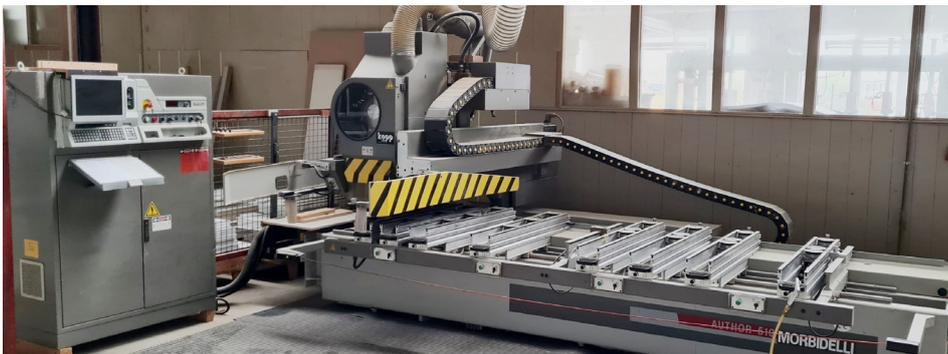
Abb. 17: CNC-Maschine mit fahrbarem Ausleger
