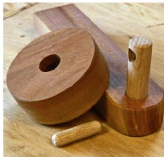
Abb. 32: Rad, Achsstummel und Splint montagefertig
