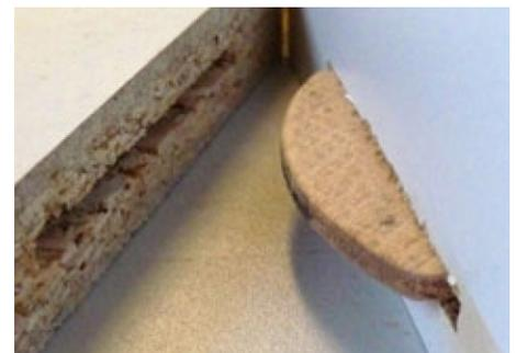
Abb. 29: Vorbereitete Flachdübelverbindung
