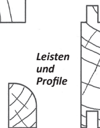
Brett: d \leq 40 mm b \geq 80 mm
