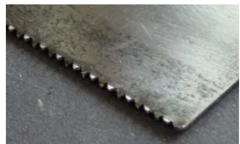
Abb. 25: Geschrängte Zahnreihe einer Feinsäge
