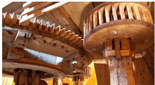
Abb. 3: Kraftübertragung bei einer alten Mühle
