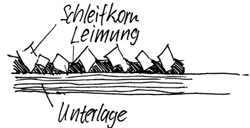
Abb. 49: Schematische Darstellung von Schleifleinen
