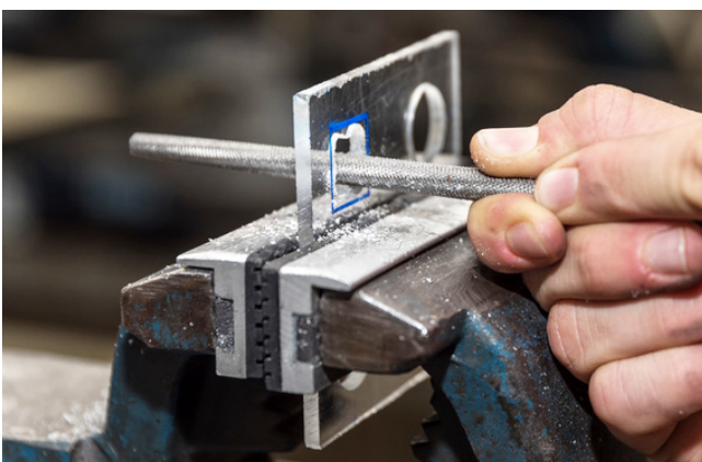
Abb. 45: Feilen eines Werkstücks aus PMMA
