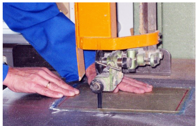
Abb. 33: Sägen einer Glasfaserplatte
