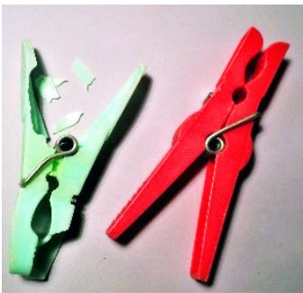
Abb. 29: Wäscheklammern: links nach zwei Jahren im Freien
