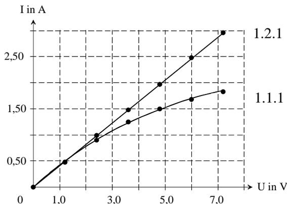
C 1.1.2 Der Widerstand des Eisendrahtes nimmt bei steigender Spannung und Stromstärke zu.
